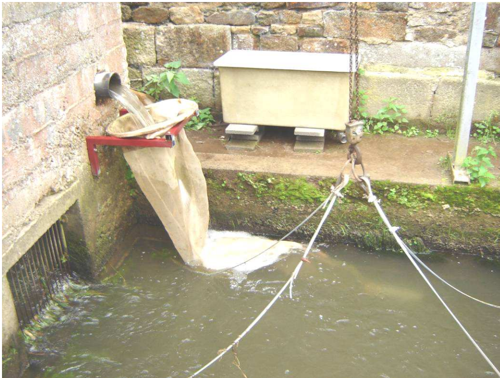
Photo 9 : Dispositif de capture des lamproies diadromes métamorphosées à l'avalaison (Photo : J. Tremblay)
