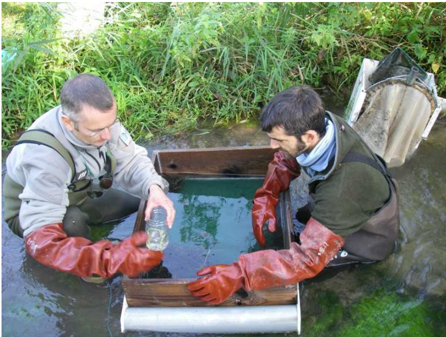
Photo 13 : Utilisation d'un tamis à maille fine (1mm) pour faciliter le tri des sédiments. (JL Fagard – ONEMA).
