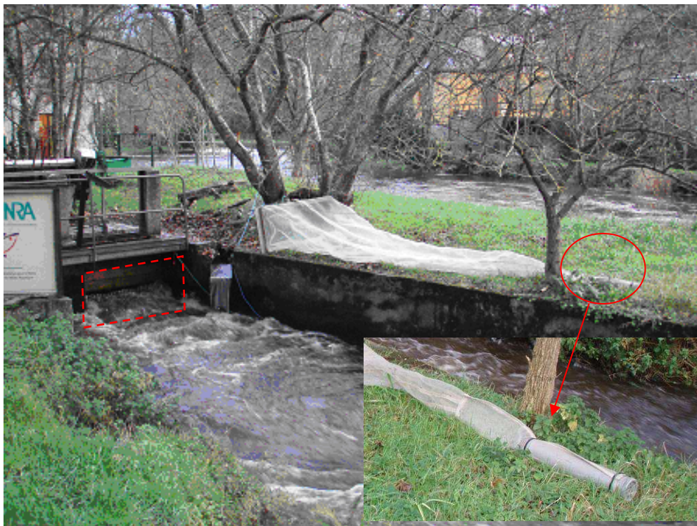
Photo 10 : Dispositif de capture des lamproies marines métamorphosées à l'avalaison. Les pointillés indiquent l'emplacement la poche (Photo : N. Jeannot).
