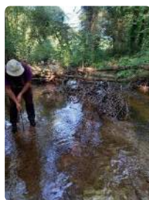
Embâcle sur radier : la mesure de la hauteur de sable permet de mesurer les conséquences de l'absence de gestion des embâcles sur les zones de production de jeunes saumons
