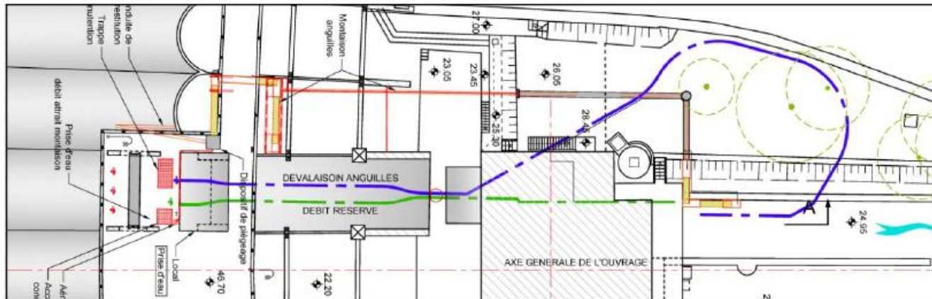
Figure 22 : Tracé des conduites
