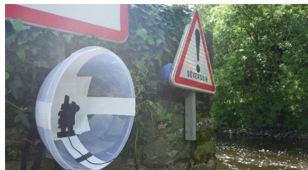
Figure 3 : dispositif d'enregistrement installé en aval de l'écluse de Trésiguidy sur l'Aulne canalisée (©BGM)
