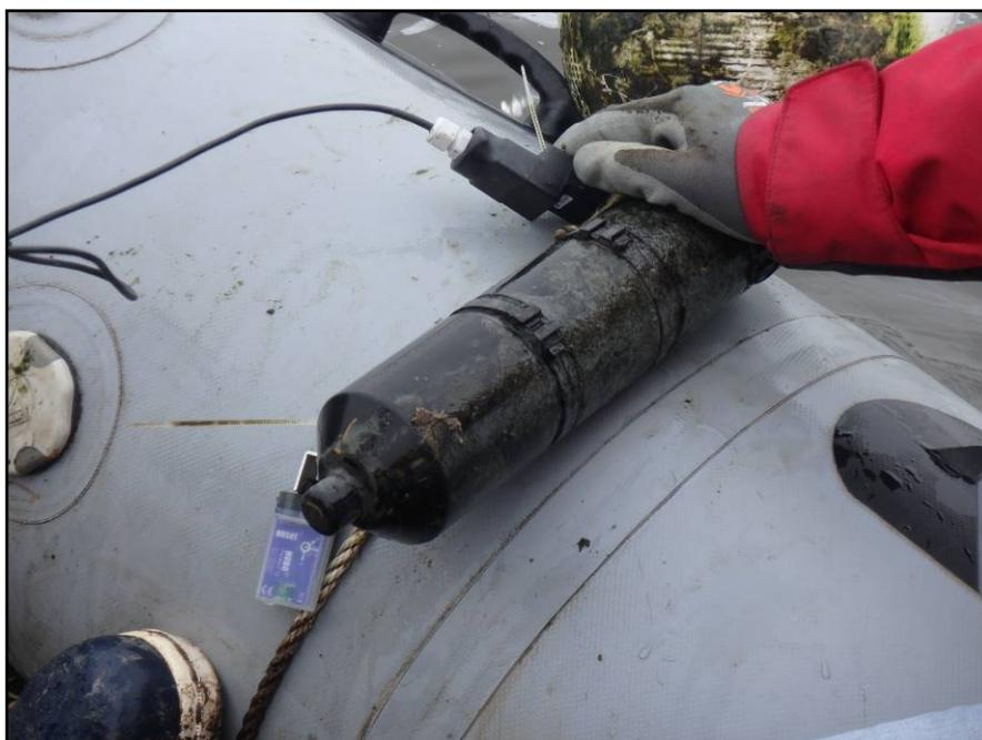
Figure 21 : Relève des données d'un capteur accéléromètre sur le Bois Joli
