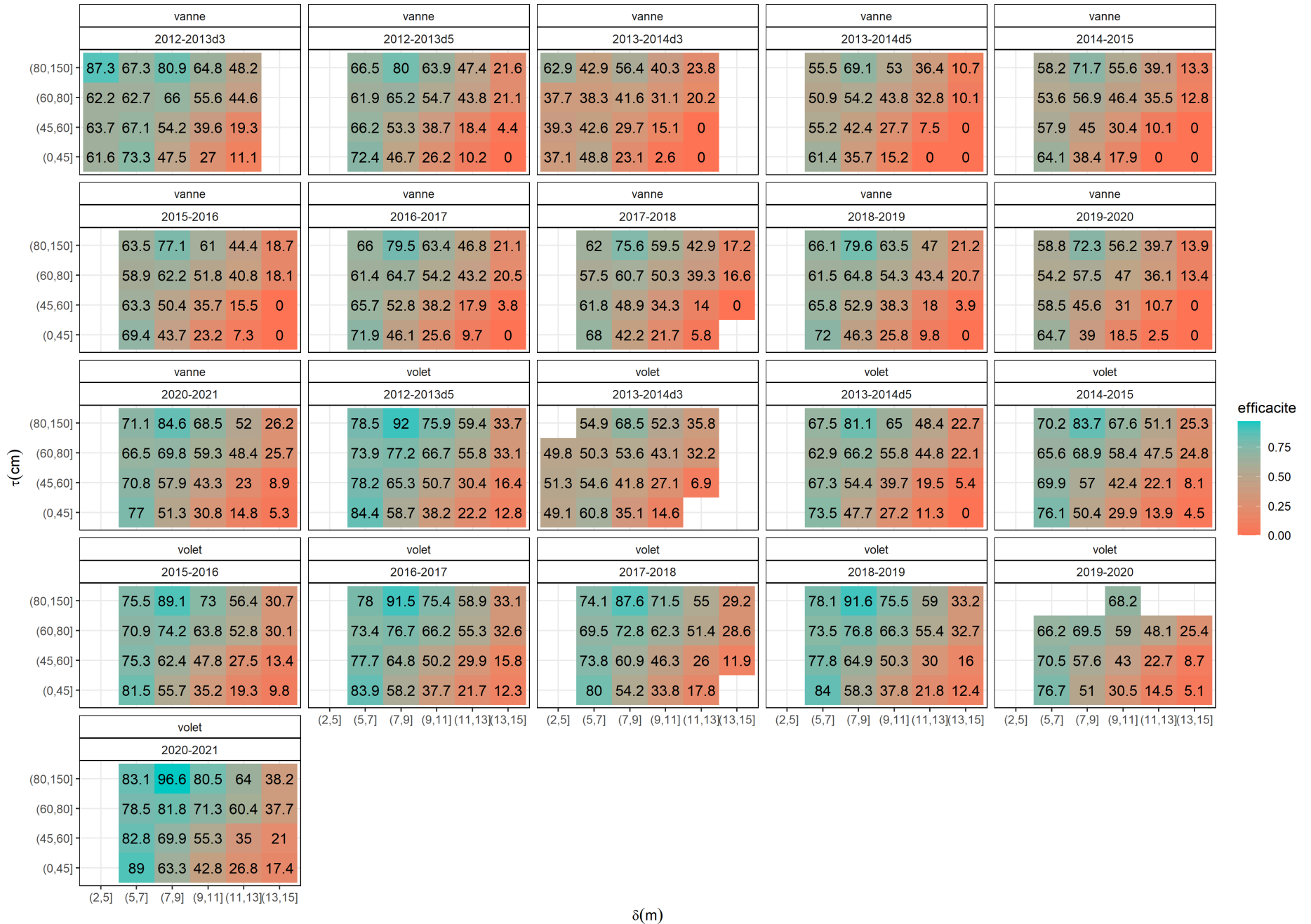
FIGURE 56 – Efficacité en fonction de la taille des anguilles et de la distance au didson, commune aux deux positions du sonar, fond et surface.
