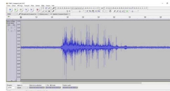
Spectre d'un bull visualisé à l'aide du logiciel de traitement des sons Audacity (source : BGM)
