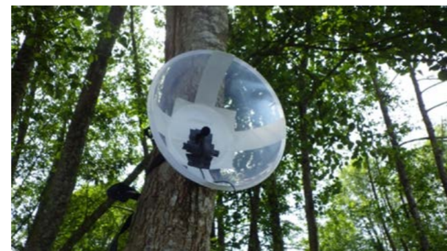
Exemple d'un dispositif d'enregistrement des bulls d'aloses (source : BGM)
